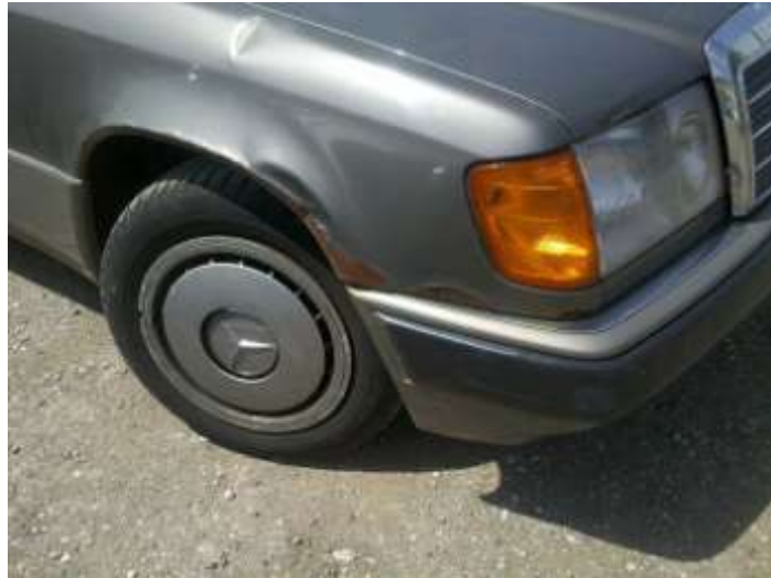
Typischer Rostschaden ohne LOKARI's am MB W124
