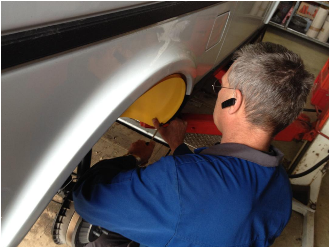
LOKARI-Radhausschalen montieren (diese sind nur aus Demo-Gründen gelb)
