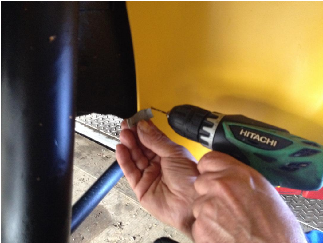
Löcher bohren, mit z.B. Mike-Sanders-Fett füllen, KFZ-Dichtmasse um Bohrloch, verschrauben
